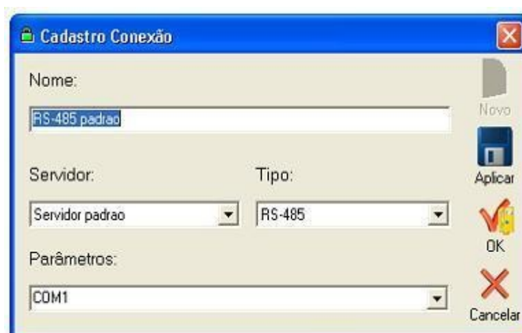
Exemplo de Conexão Serial RS-485 na porta serial COM1 (Padrão de Fábrica)
