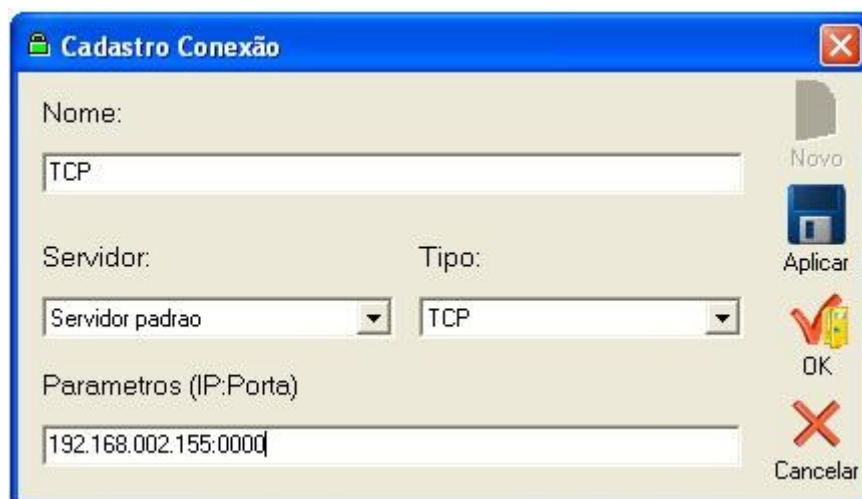
Exemplo de Conexão Ethernet TCP/IP
